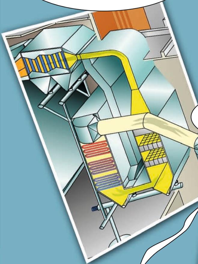
Durch das Feuer wird in einem speziellen Röhrensystem, das durch die Flammen und den heißen Rauch geführt wird, Wasser ...
